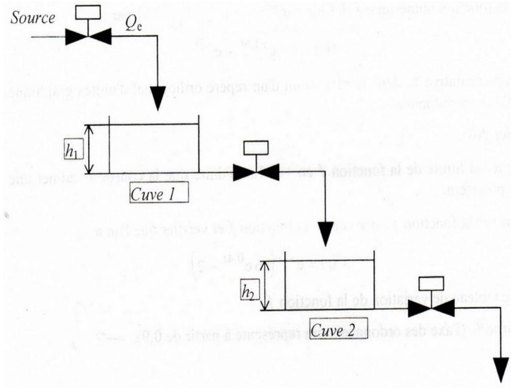
Cuve 1: filtre à sable de section  $S = 100 \text{ m}^2$
